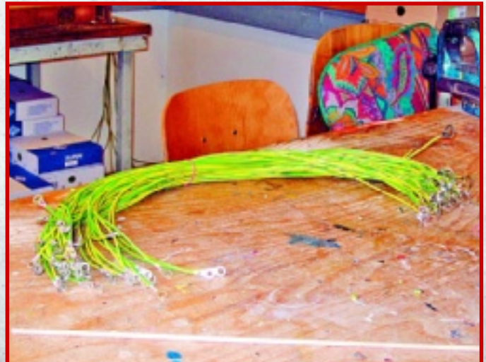
Erdungskabel aus der Kabelfertigung in der Werkstatt der JVA. Die Mitarbeiter durften nicht fotografiert werden.
